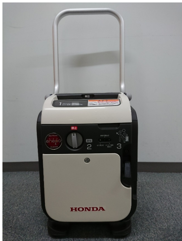
(30 年度整備 簡易発電機 最大出力 900VA)
